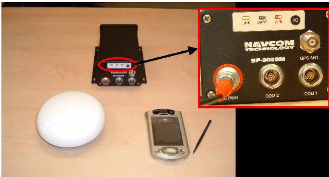
Figura 3. Strumentazione utilizzata nelle prove: antenna, ricevitore NavCom SF-2050M, palmare con software PfGPS. Nel riquadro i "led" relativi alla qualità del collegamento StarFire e quelli associati al posizionamento GPS.
