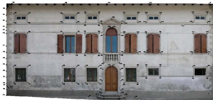
unione fra il fotogramma finale e i punti del rilievo topografico
