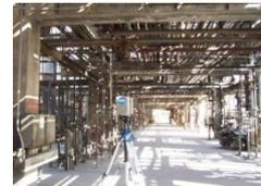
Il laser scanner assieme a software applicativi dedicati, consente di velocizzare le operazioni di rilievo ed elaborazione di siti industriali complessi, grazie alla associazione tra immagine e scansioni in automatico, consentendo di ottenere un database digitale e tridimensionale degli impianti presenti (piping).
