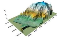
In Geologia il laser scanner permette la creazione di DEM (Digital Elevation Model) con elevato dettaglio per la verifica, anche in condizioni di emergenza, della stabilità dei versanti e calcolo caduta massi. L'interfacciamento con il GPS consente una georeferenziazione veloce ed automatica.
