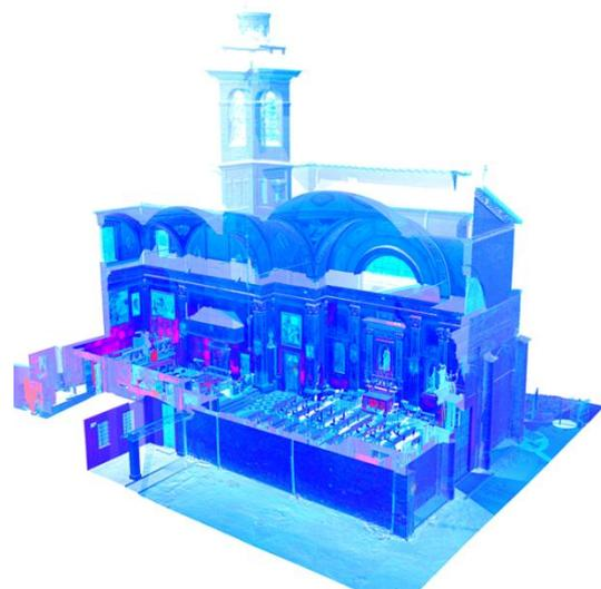
Lo scanner ha la capacità di acquisire una elevata quantità di dati, permettendo di rilevare qualsiasi oggetto architettonico con una maglia quadrata di punti fino ad una risoluzione di 6mm x 6mm, dalla quale è possibile ricostruire la perfetta geometria dell'oggetto rilevato.
