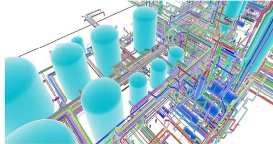
Il laser scanner assieme a software applicativi dedicati, consente di velocizzare le operazioni di rilievo ed elaborazione di siti industriali complessi, grazie alla associazione tra immagine e scansioni in automatico, consentendo di ottenere un database digitale e tridimensionale degli impianti presenti (piping).
