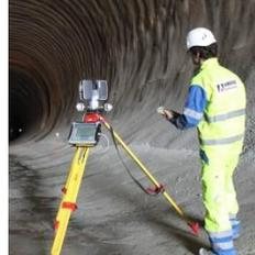
In ambito territoriale il laser scanner, con l'interfacciamento GPS, permette una veloce georeferenziazione del rilievo 3D. Consente di rilevare in tempi velocissimi, una quantità di dati notevole con altissimo dettaglio che potranno essere utilizzati per il calcolo di sezioni, curve di livello e volumetrie. Il sistema di rilevamento permette di raggiungere anche zone inaccessibili.
