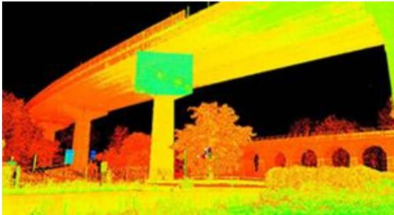
Consente di rilevare in tempi velocissimi, una quantità di dati notevole con altissimo dettaglio che potranno essere utilizzati per il calcolo di sezioni, curve di livello e volumetrie. Il sistema di rilevamento (time of flight) permette di raggiungere anche zone inaccessibili.
