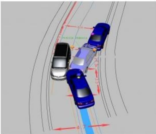
Nell'ambito di incidenti stradali, rispetto alle normali tecniche di rilevamento con cordella metrica, questa tecnologia garantisce una scansione tridimensionale accurata e completa della scena dell'incidente con dettagli quali le deformazioni dei veicoli o tracce di sbandate.
