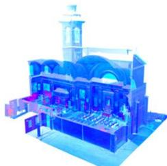
Il laser scanner associa in automatico immagini ad alta risoluzione (10 Mpixel) alle nuvole di punti che rappresentano la geometria 3D delle architetture. In questo modo i dettagli
