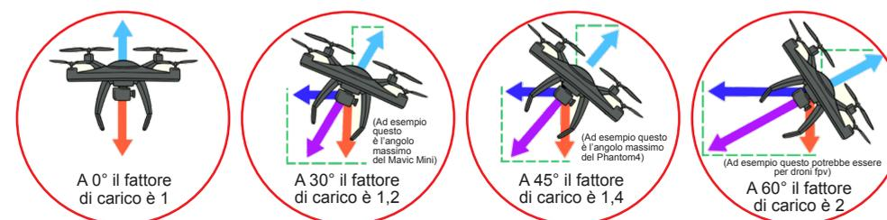
In teoria, G diventerebbe infinito a 90° poiché la componente verticale della portanza diventa zero e non può sostenere il peso dell'aeromobile. Tuttavia, in pratica, un aeromobile non può mantenere una virata stabile a 90° di inclinazione laterale senza perdere quota o velocità.
