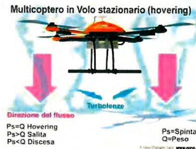
Per farla semplice, quando le 4 eliche di un drone ruotano alla stessa velocità il drone rimane in hovering ovvero si libra in aria mantenendo un assetto stabile ed immobile. Alzando la leva del gas (chiamata anche THROTTLE o acceleratore), i quattro motori incrementano il numero di giri facendo sollevare il drone e vice versa per farlo scendere verso il basso.
