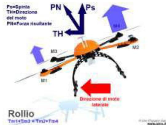
Per la manovra di Picchiata o di Cabrata e cioè il movimento che avviene attorno all'asse laterale, per poter far traslare in avanti o all'indietro il multirottore, valgono esattamente le stesse identiche regole che riguardano il Rollo, dunque ( $T_{m1}+T_{m2} < T_{m3}+T_{m4}$ ).
