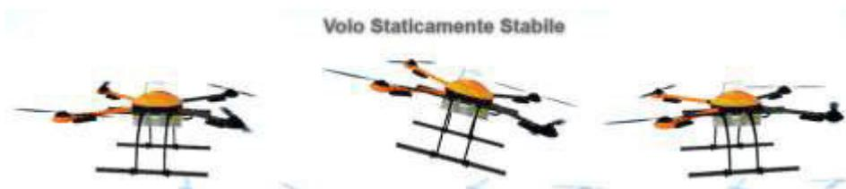
Se l'aeromobile continua a modificare l'orientamento o l'assetto dopo il disturbo, allora si definisce la macchina **STATICAMENTE INSTABILE**.
