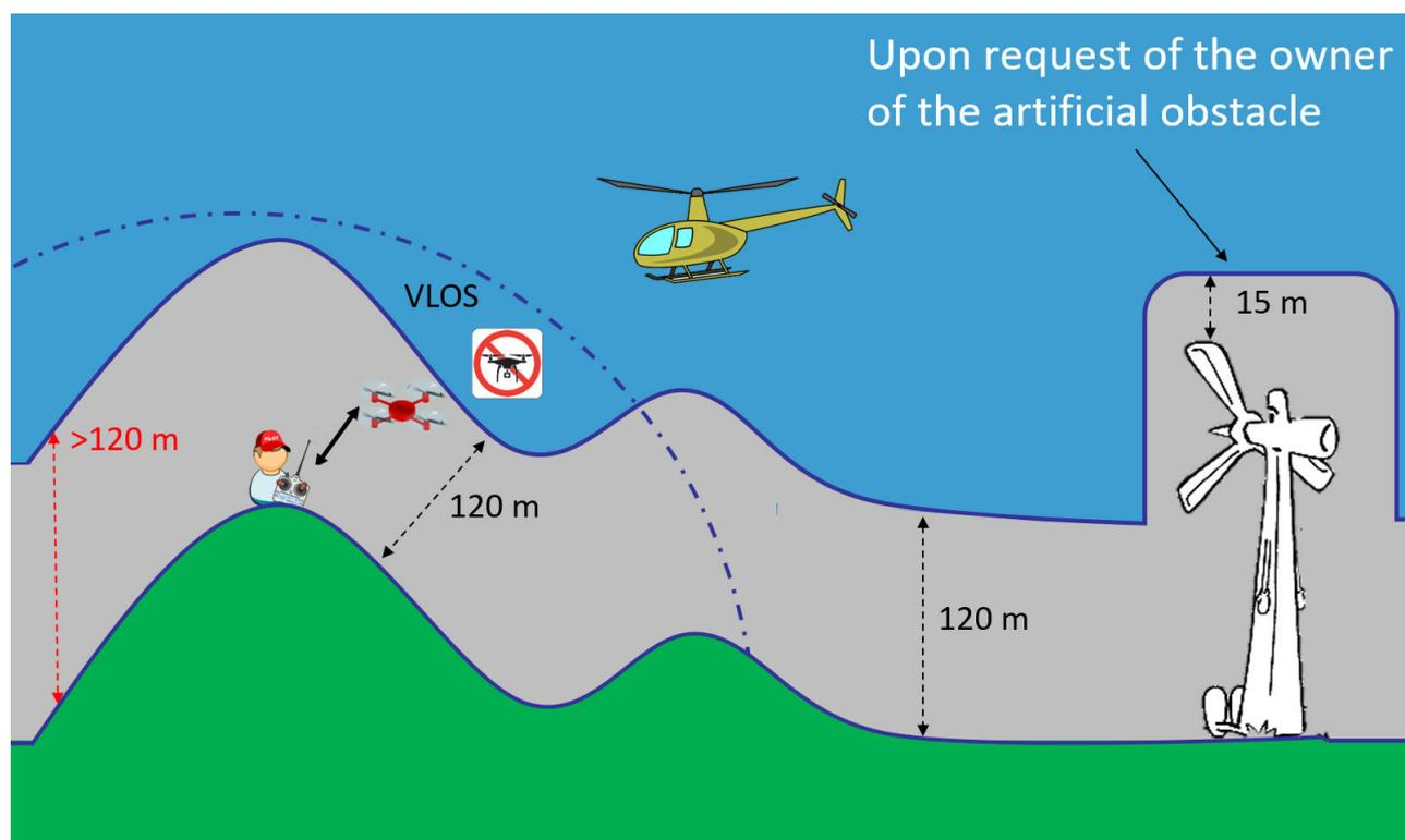
L'ente responsabile dell'eventuale ostacolo artificiale deve concedere esplicitamente all'operatore del UAS l'autorizzazione a condurre un'operazione vicino all'ostacolo artificiale, ad esempio un edificio o un'antenna. Nessun operatore UAS potrà condurre un'operazione in prossimità di tale ostacolo senza l'autorizzazione del soggetto responsabile dell'ostacolo. (Cfr. GM1 UAS.OPEN.010)
