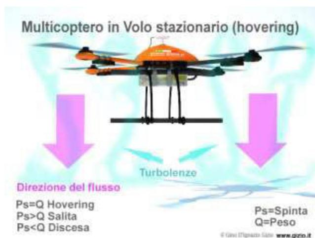
Per farla semplice, quando le 4 eliche di un drone ruotano alla stessa velocità il drone rimane in hovering ovvero si libra in aria mantenendo un assetto stabile ed immobile. Alzando la leva del gas (chiamata anche THROTTLE o acceleratore), i quattro motori incrementano il numero di giri facendo sollevare il drone e vice versa per farlo scendere verso il basso.
