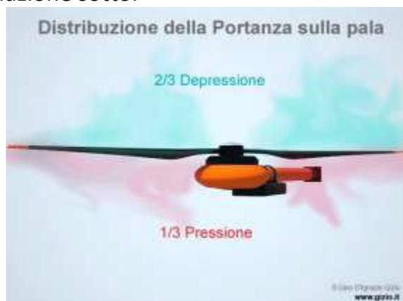
Riepilogando, in un multicottero le ali sono sostituite dalle pale del rotore, una elica particolare progettata per lo scopo, che viene fatta ruotare ad alta velocità per raggiungere le stesse condizioni di un'ala di un aeroplano, ma diversamente da essa aventi una rivoluzione intorno ad un centro di rotazione, seguendo cioè un circolo definito che crea una superficie virtuale chiamata Disco Rotore.
